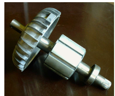
Rys.1.1 Bezsztotkowy silnik prądu stałego poddany wstępnej analizie (a), rdzeń stojana z uzwojeniem trójfazowym oraz obudową (b), wirnik wykonany z litego materiału z usytuowanymi magnesami z pierwiastków ziem rzadkich (c).
